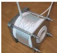
当社の小型管状炉製作技術を駆使して製作した、ノズル用ヒーター（超小型管状炉）です。内側がセラミック管となっており、ノズルへの締め込みが出来ません。従ってノズル径よりやや大きく内径を製作します。
