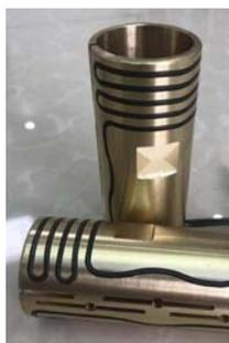
細いシーズヒーターに合わせた溝を、真鍮筒に加工して製作されています。
